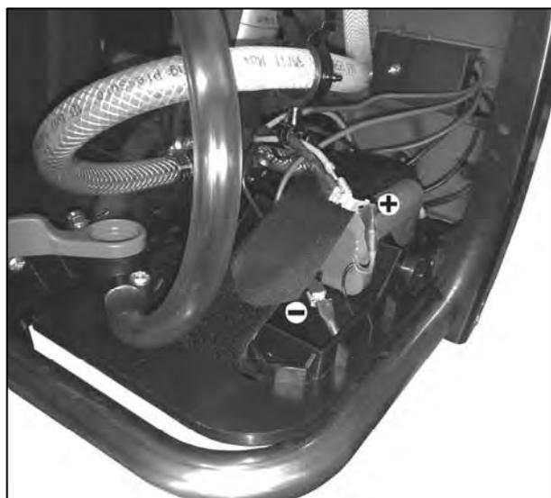
**Polo positivo:** Collegare il filo rosso spina della batteria sul connettore del cavo con il cavo rosso. Questo connettore cavo è fissato con una fascetta sul tubo superiore.
