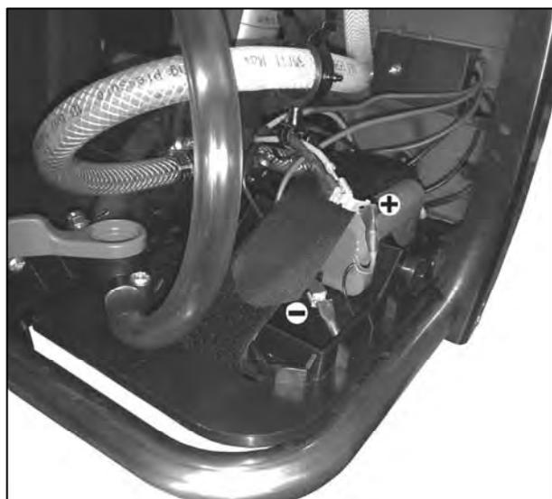
**Plus-pool:** Bevestig de rode draad sluit de batterij op de kabel connector met de rode kabel. Deze connector is beveiligd met een klem op de bovenste slang.
