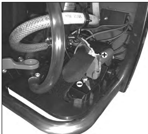
**Pôle plus :** Fixez le connecteur de câble rouge de la batterie sur la prise du câble rouge. Ce connecteur de câble est fixé avec une pince sur le tuyau d'eau supérieur.
