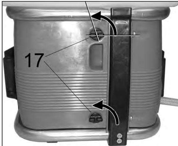
Die beiden Verschlussknöpfe (17) zum Öffnen des Schutzgehäuses etwa 100° gegen den Uhrzeigersinn drehen, Schutzgehäuse öffnen.
