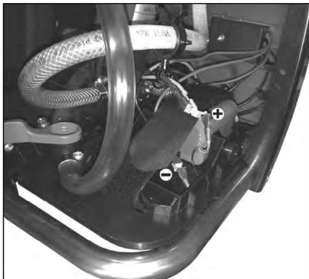
**Polo positivo:** Conecte el conector rojo del cable macho de la batería con enchufe del cable rojo. Este conector de cable se asegura con una abrazadera en la manguera de agua superior.
