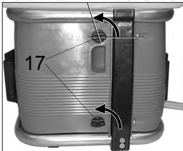
Girare i due pulsanti di chiusura (17) del rivestimento di protezione circa 100° in senso antiorario. Aprire il rivestimento di protezione.
