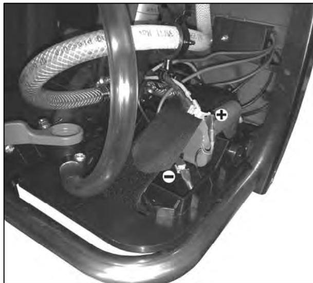
**Pluspol:** Den roten Kabelstecker des Akkus auf den Kabelstecker mit den zwei roten Anschlusskabeln aufstecken. Dieser Kabelstecker ist mit einer Schelle an dem oberen Wasserschlauch befestigt.
